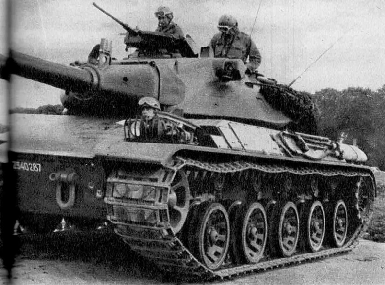
Voici le char français AMX-30. C'est le plus léger des grands chars européens: 32,5 t seulement. Il est armé d'un canon de 105 mm à « charge creuse ». Son moteur polycarburant est capable de fonctionner à « tout ce qui brûle », du pétrole brut jusqu'à l'huile végétale.
