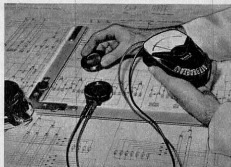
Luxmétrie - éclairagisme : toutes mesures d'éclairage de 0 à 1.000 et 0 à 10.000 lux.
