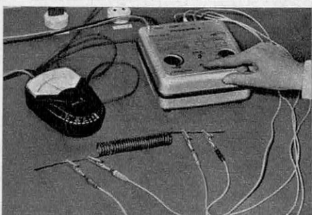
Milliohmètre pour l'essai et la mesure des résistances faibles, inférieures à 10 ohms. Exemples : fils résistants, bobinages de moteurs, etc...
