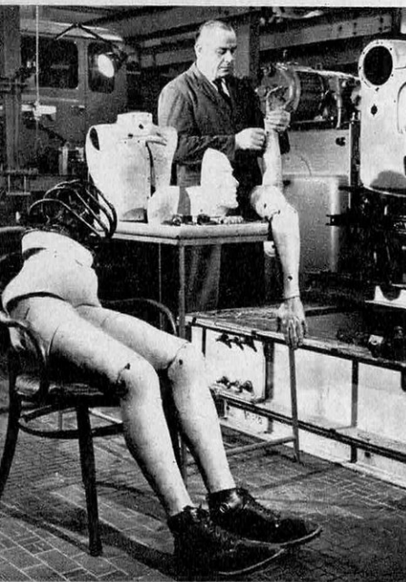
Assemblé pièce par pièce le mannequin servira aux ergonomistes pour la prévention des accidents.
