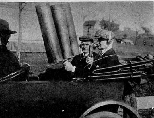
Mc Farlane, en 1919, invente le téléphone sans fil à trois tubes récepteurs.
