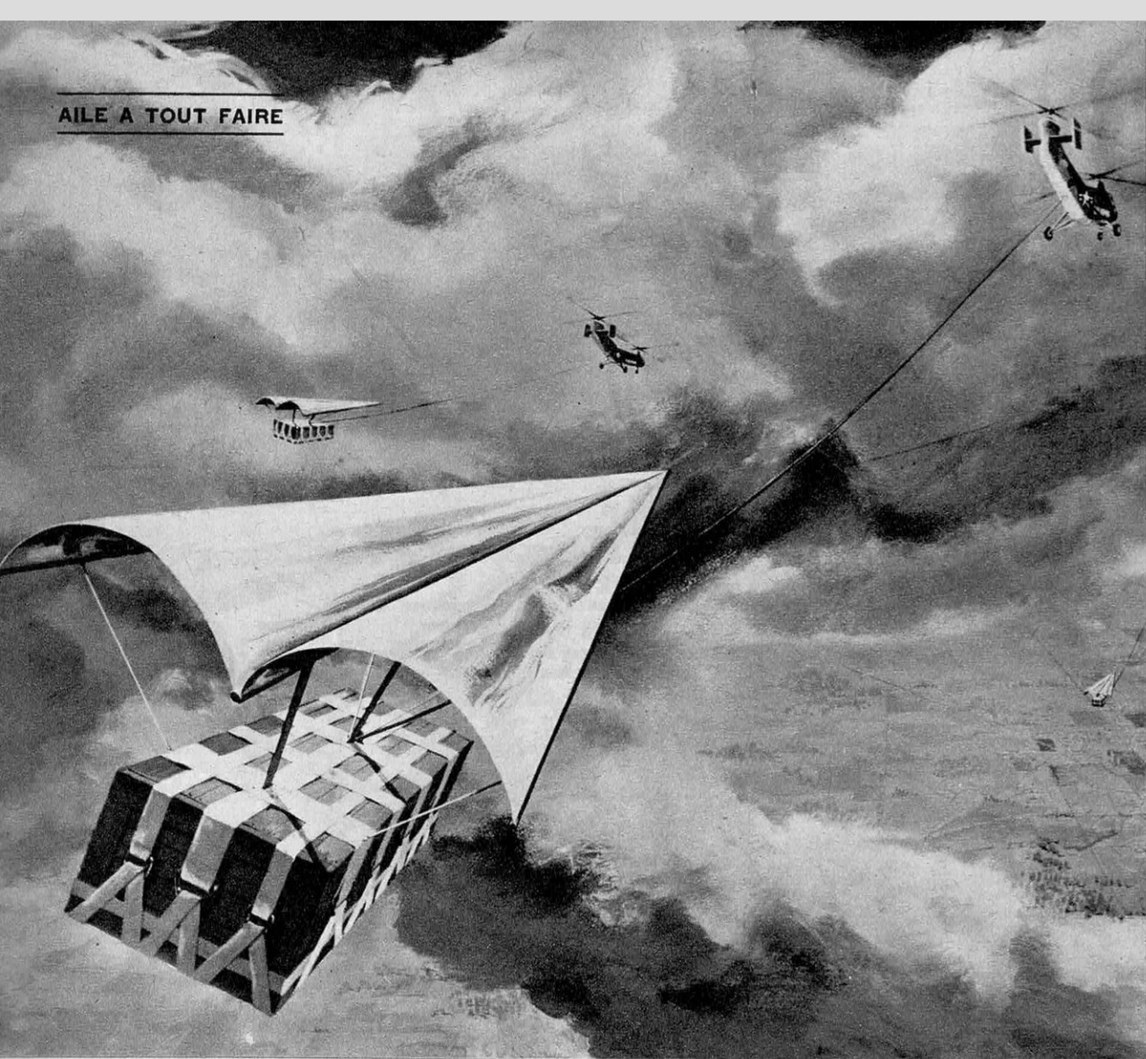
CES « BANANES » POURRONT REMORQUER, GRACE A L'AILE DE ROGALLO, UNE CHARGE DE 10 T.
