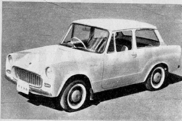
PUBLICA : la toute dernière nouveauté de Toyota Motors. C'est une voiture de 697 cm 3 , à 2 cylindres opposés, refroidissement par air, développant 30 ch. Vitesse maximum: 110 km/h.
