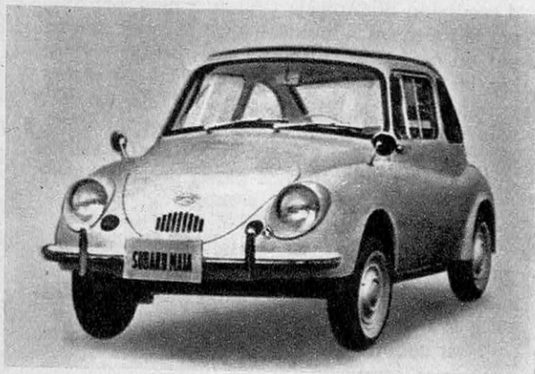
SUBARU : la plus populaire des petites voitures destinées au marché intérieur. C'est une 4 places, décapotable, mue par un moteur de 423 cm 3 à 2 cylindres, de 22 ch, et roulant à 100.
