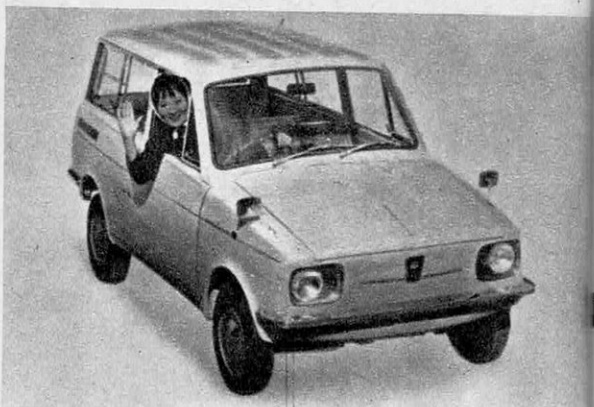
CONY 360 : modèle représentatif de la construction japonaise dans le domaine du petit véhicule utilitaire. Un moteur de 354 cm 3 (19 ch) l'entraîne à la vitesse de 80 km/heure.
