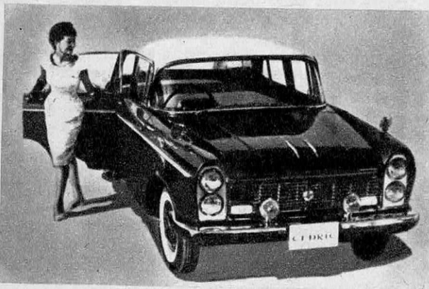
CEDRIC 1900 : un modèle « 1962 » qui paraît avoir été dessiné en Italie. Il est équipé d'un moteur de 1 883 cm 3 développant 95 ch et pouvant entraîner 6 personnes à 140 km/h.
