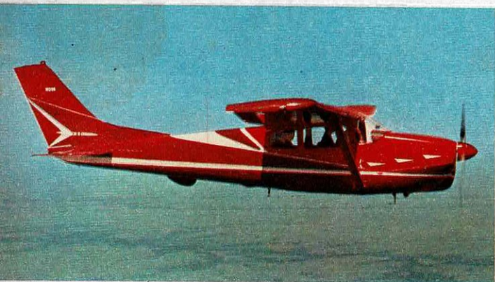
QUADRUPLACE CESSNA, modèle 210. Unique en son genre, avec son aile haute et son atterrisseur escamotable.
