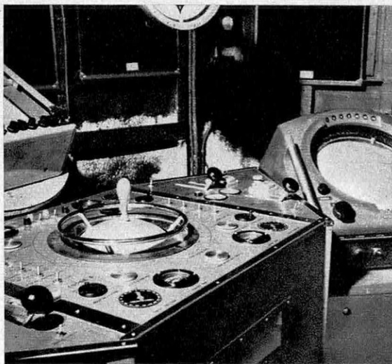
LA BARRE DE STABILISATION DU CUSS 1 : un manche à balai monté sur rotule, que le timonier manœuvre en se guidant sur les écrans radar et sonar.
