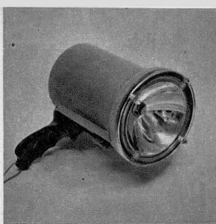
Sur le projecteur « Cristal », étanche à 100 mètres et équipé d'une pile 9 volts, le contact est assuré par un aimant coulissant dans une gorge.
