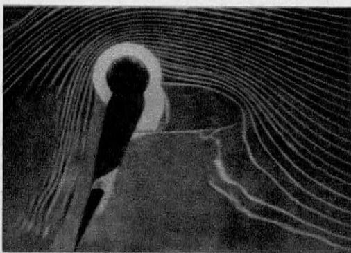
LE CYLINDRE TOURNE. Le flux est infléchi de 90° sans la moindre turbulence gâcheuse d'énergie.
