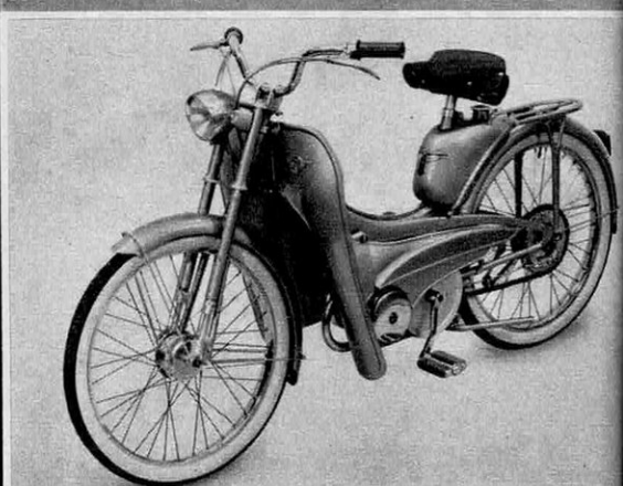
Le nouveau modèle AV 44 est doté d'un cadre de conception originale dans lequel la partie avant est constituée par une poutre rigide en tôle avec cloison intérieure.
