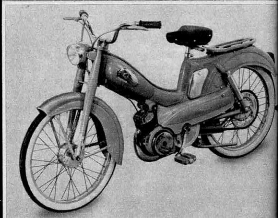
Sur le type de Mobylette AV 68 sorti au mois d'octobre, l'embrayage et le changement de vitesse sont tous deux automatiques. Le cadre poutre forme le réservoir.
