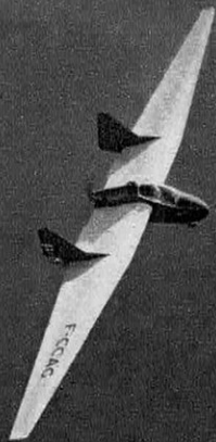
Ce planeur sans queue est l'aile volante Fauvel AV 45. Il est muni d'un moteur 4 cylindres, 2 temps.
