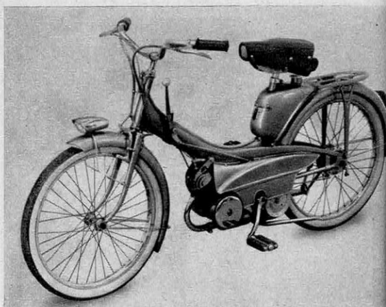
La Mobylette BG 43 à transmission par courroie-galet. Le moteur occupe le même emplacement à la partie inférieure du cadre que sur tous les autres modèles.
