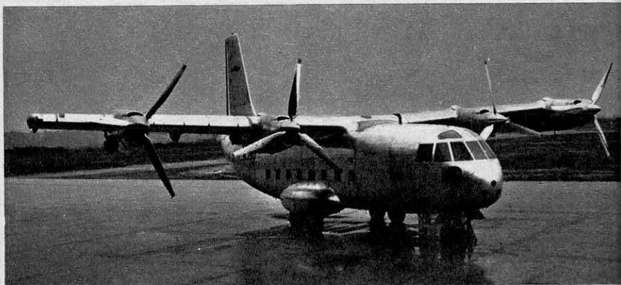
Le STOL Bréguet 941 (20 tonnes) décolle en 230 mètres.
