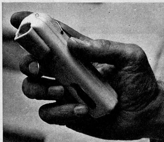
Ci-dessous : Le « Télé-Appel » des Ets Redal qui tout équipé — avec sa batterie — son potentiomètre, son haut-parleur, etc. ne pèse que 115 grammes. Un clip permet d'accrocher à la poche ce minuscule récepteur.
