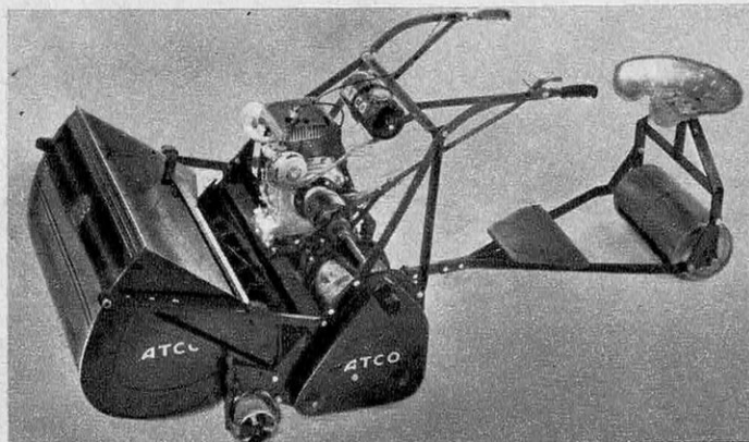
Atco : Moteur 4 temps refroidi par ventilateur. Cylindre à 6 lames renforcées. Rouleau à 3 sections avec différentiel auto-graisseur. Poids: 140 kg. Coupe de 71 cm. Consommation 1 litre/heure. Prix: 3 700 NF.
