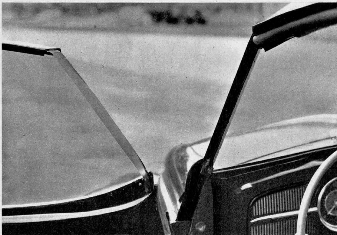
L'épaisseur de la vitre latérale — 20 mm — est très visible sur cette photo, ainsi que la façon dont le bord
