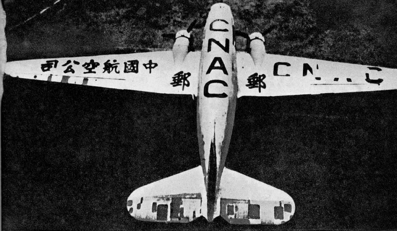
Le fameux DC-2 1/2: un DC-3 manchot, auquel on a greffé une aile de DC-2.
