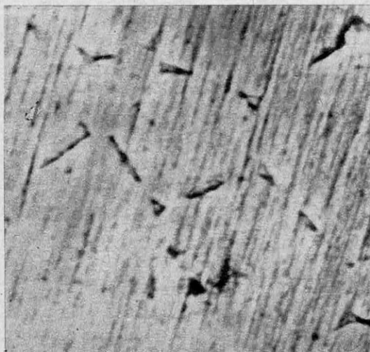
Un alliage aluminium-étain examiné par réflexion au microscope ordinaire (à gauche) et la radiographie du même alliage au microscope à rayons X révélant sa structure interne (à droite).
