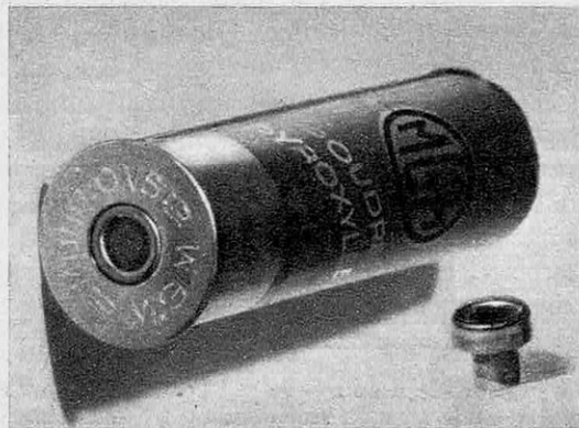
La cartouche a le même aspect que celle du fusil classique. Seule diffère l'amorce dans laquelle une résistance électrique met le feu à la poudre.
