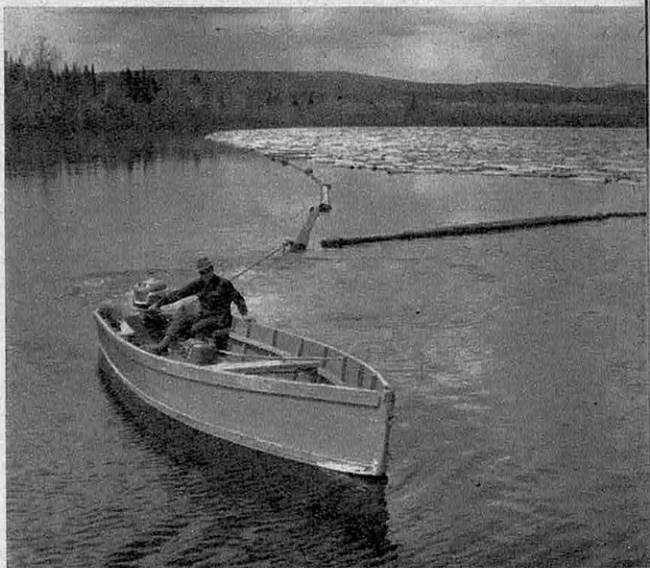
Au Canada, des hors-bord à l'hélice protégée par une grille servent au convoyage des bois.
