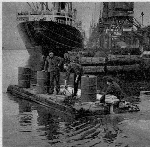
Au Havre, ce radeau de ravalement naval s'est affranchi du service coûteux des remorqueurs
