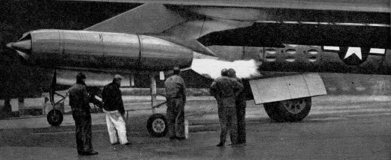
Un inverseur de jet expérimenté sur les réacteurs du Stratotanker de l'U. S. Air Force.
