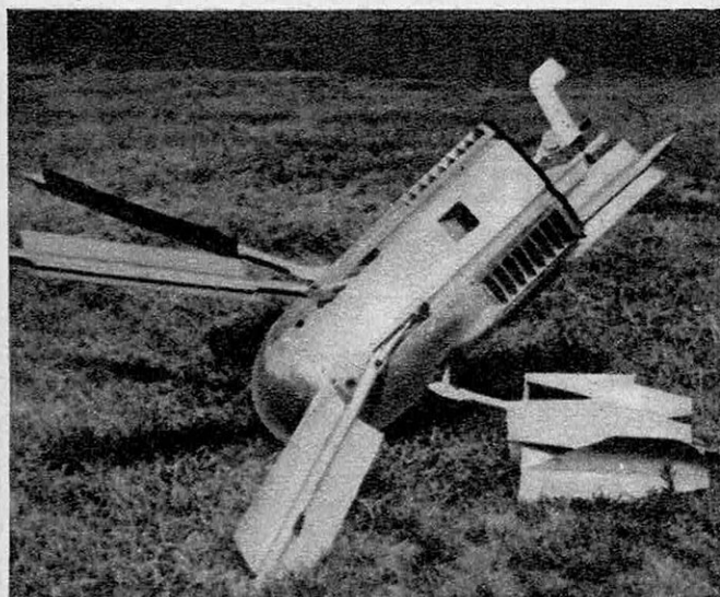
L'appareil se redresse lentement, prenant appui même sur un terrain très inégal.
