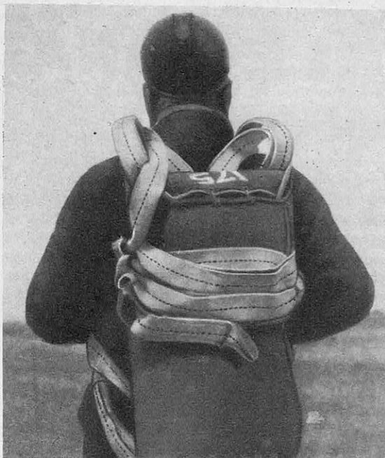
● Le parachute dorsal. Celui-ci est à ouverture automatique comme l'indique la sangle lovée dans des élastiques sur les bords du sac. (Photo Maximilien.)
