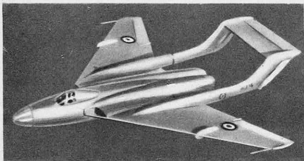
DE « HAVILLAND 110 » équipé de deux turboréacteurs « Avon ». Ce chasseur tous temps est en principe destiné aux combats aux vitesses supersoniques.
