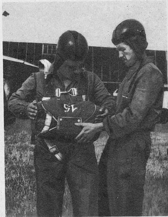
● Contrôle de l'équipement avant le départ. Le parachute ventral ne sert qu'au cas où le dorsal ne fonctionne pas. Une poignée (à gauche) le commande.
