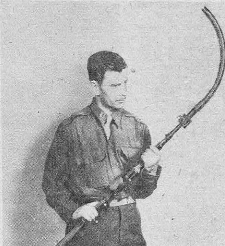
FIG. 13. — LE FUSIL COURBE ALLEMAND « POUR TIRER DANS LES COINS »
