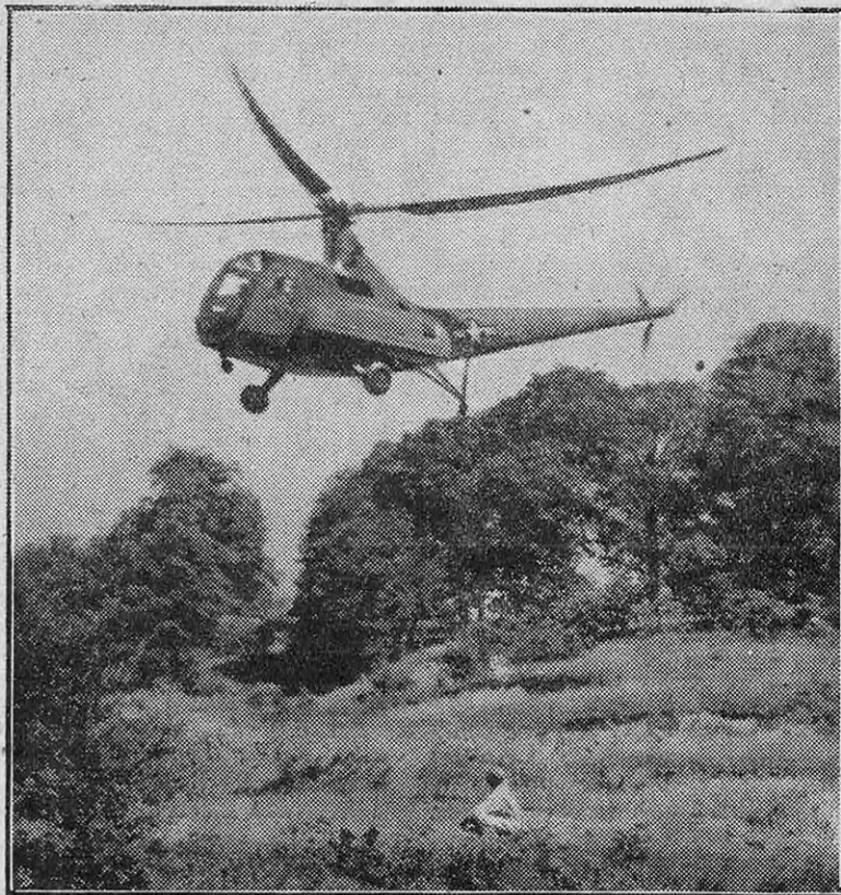
FIG. 4. — DESCENDANT A LA VERTICALE, UN HELICOPTERE DU TYPE ADOPTE PAR L'ARMEE AMERICAINE, VA SE POSER SANS DIFFICULTE SUR UN TERRAIN DE FORTUNE (O. W. I.).
