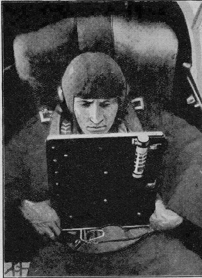
FIG. 9. — UNE INSTALLATION RADIOGRAPHIQUE A BORD D'UN BOMBARDIER ALLEMAND JUNKERS 87 POUR L'ÉTUDE DES EFFETS PHYSIOLOGIQUES DES ACCÉLÉRATIONS
