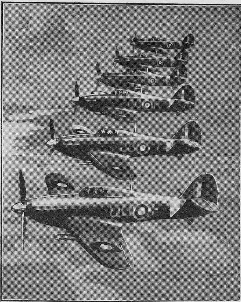
FIG. 6. — UNE PATROUILLE DE HAWKER « HURRICANE » II C ARMÉS DE QUATRE CANONS DE 20 MM
