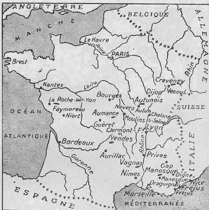
FIG. 3. — CARTE DES PRINCIPAUX GISEMENTS FRANÇAIS DE SCHISTES BITUMINEUX
