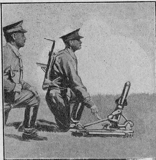
FIG. 5. — LE MORTIER DE TRANCHÉE SAMAIA DONT L'EMPENNAGE COIFFE LE CANON
