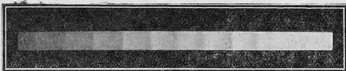
FIG. 5. — ÉCHELLE DE NOIRCISSEMENT D'UN FILM RADIOGRAPHIQUE OBTENUE PAR LA MÉTHODE DES SECTEURS TOURNANTS
