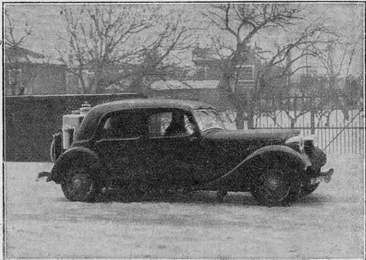
FIG. 3. — VOITURE CITROËN 7-9 CH ÉQUIPÉE AVEC UN GÉNÉRATEUR LILOR
