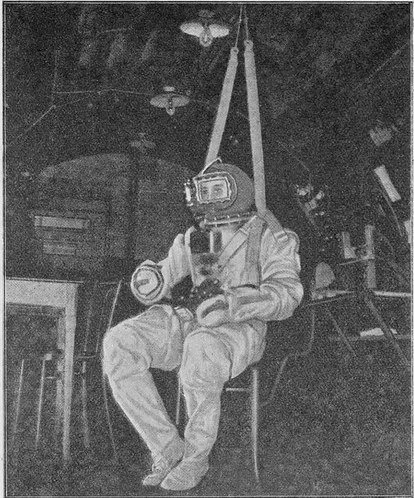
FIG. 7. — LE SCAPHANDRE AÉRIEN ROSENSTIEL ET GARSAUX T W 2979
