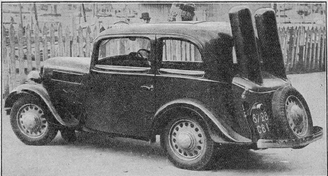
FIG. 6. — INSTALLATION DE BOUTEILLES D'ACÉTYLÈNE SUR UNE VOITURE 5 CH ROSEGART (M. HEYRAUD, A MARSEILLE)
