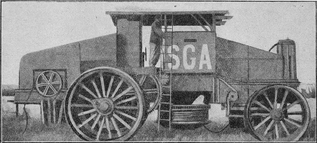
FIG. 3. — TREUIL AUTOMOTEUR TYPE 20 TONNES, MOTEUR 100 CHEVAUX
