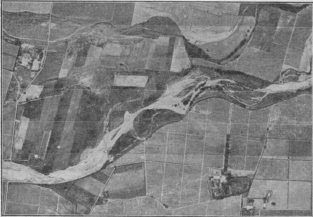
FIG. 6. — PLAN PHOTOGRAPHIQUE RESTITUÉ PAR LA MÉTHODE DU SCINTILLEMENT
