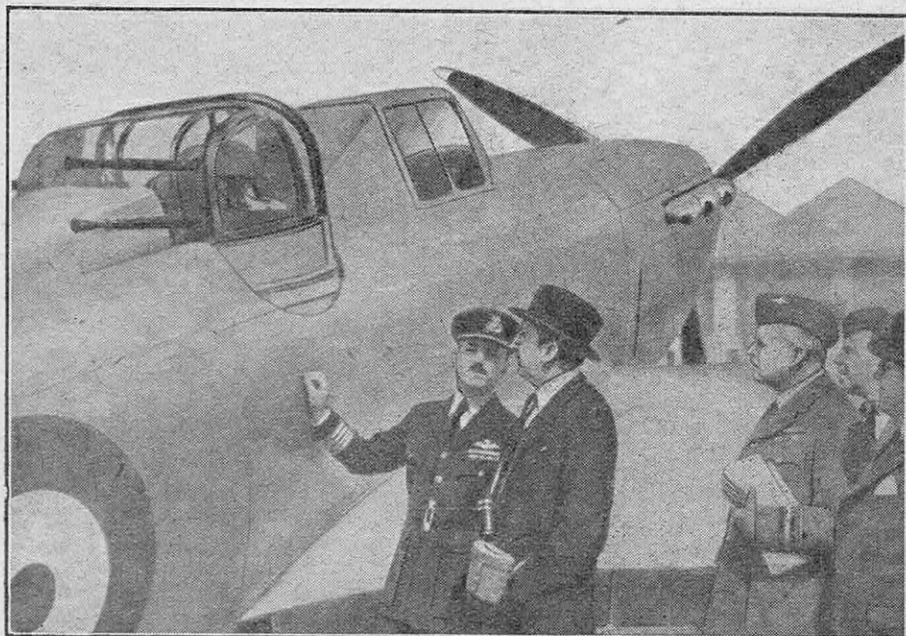
FIG. 10. — LA TOURELLE QUADRUPLE DU NOUVEL AVION DE COMBAT BRITANNIQUE BOULTON AND PAUL « DEFIANT »
