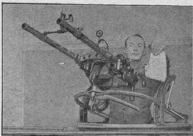
FIG. 9. — DEUX MITRAILLEUSES MADSEN DE 7,9 MM JUMELÉES DANS UNE TOURELLE. CADENCE DE TIR GLOBALE : 2 400 COUPS PAR MINUTE (D'APRÈS « ARMAT »),
