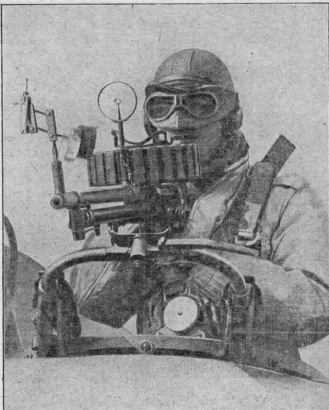
FIG. 6. — UNE MITRAILLEUSE LEWIS SUR TOURELLE A BORD D'UN AVION D'ENTRAÎNEMENT DE LA FLEET AIR ARM (AVIATION NAVALE ANGLAISE)
