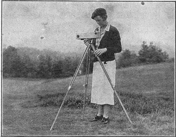
FIG. 4. — TÉLÉMÈTRE DE 30 CM DE LONGUEUR DE BASE POUR RELEVÉS TOPOGRAPHIQUES
