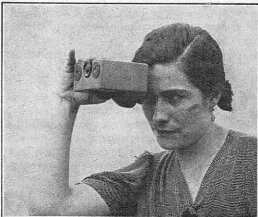
FIG. 3. — TÉLÉMÈTRE PORTATIF DE 75 MM DE BASE POUR FAIBLES DISTANCES
