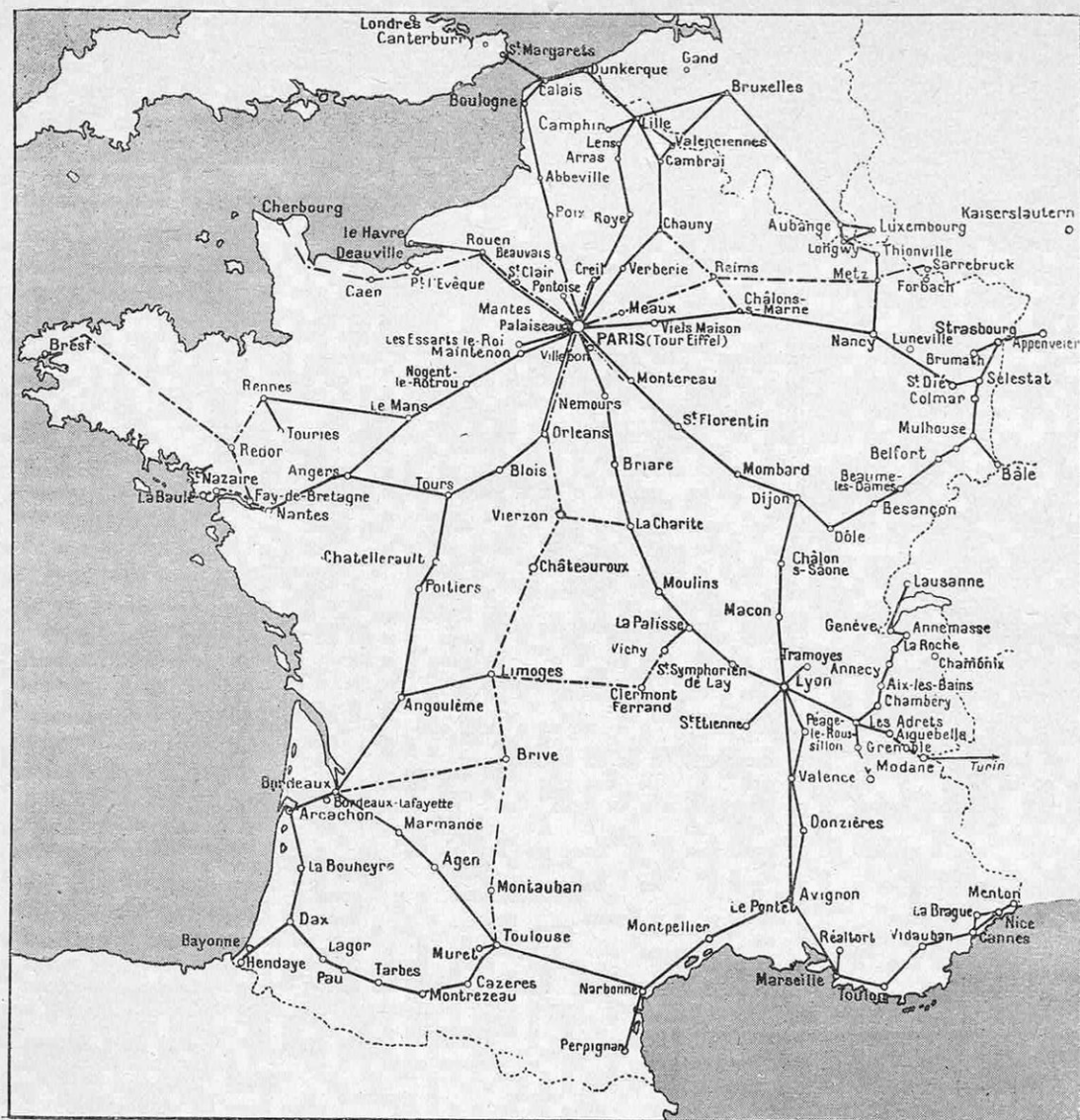
FIG. 11. — CARTE DU RÉSEAU DES CABLES SPÉCIAUX QUI RELIENT LES ÉMETTEURS ET LES STUDIOS DU RÉSEAU D'ÉTAT FRANÇAIS DE RADIODIFFUSION
