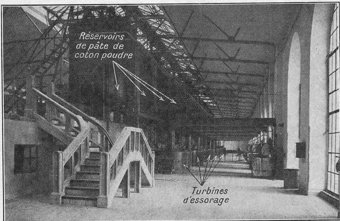
FIG. 6. — VUE D'UN ATELIER DE FABRICATION DU COTON-POUDRE (USINE ALLEMANDE) A gauche, les grands réservoirs dans lesquels arrive la pâte de coton-poudre stabilisé. Ils sont en charge sur des séries de turbines dans lesquelles s'effectue l'essorage final.
