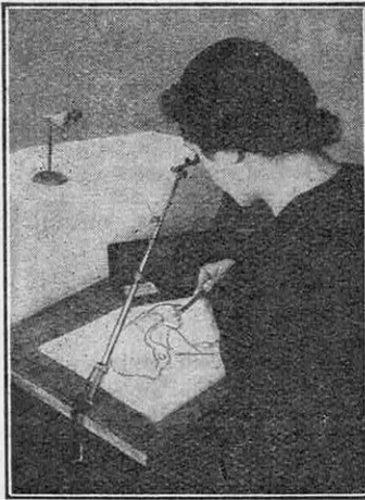
COMMENT ON REPRODUIT UN SUJET EN L'AGRANDISSANT AVEC LA « CHAMBRE CLAIRE UNIVERSELLE »
