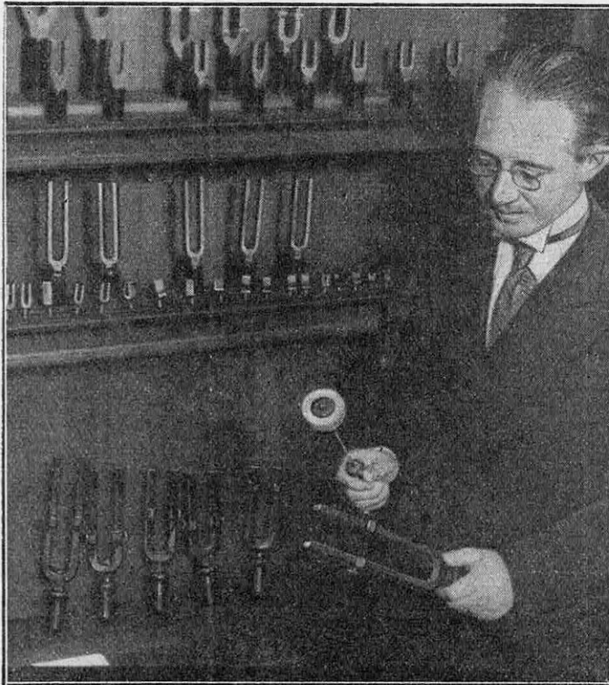
FIG. 4. — LA SYNTHÈSE DES VOYELLES RÉALISÉE PAR LES DIAPASONS RÉGLABLES DE KœNIG
