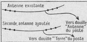
FIG. 2. — UN « CONTREPOIS » PEUT REMPLACER UNE PRISE DE TERRE
