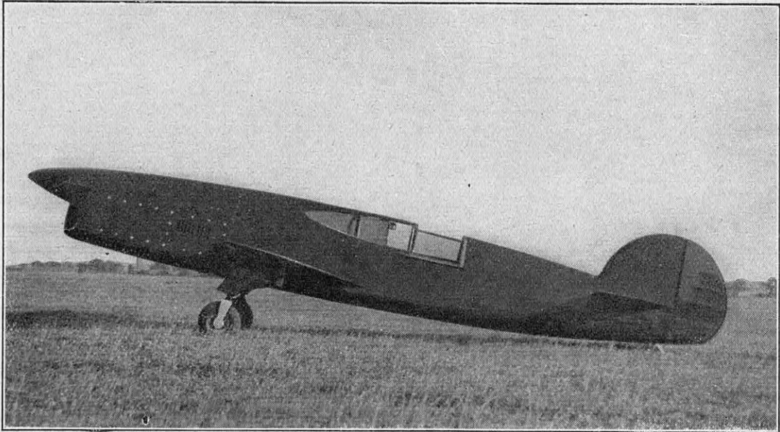
FIG. 6. — LE « CAUDRON » DE LA COUPE DEUTSCH (443,965 KM/H AVEC 8 L. DE CYLINDRÉE)
