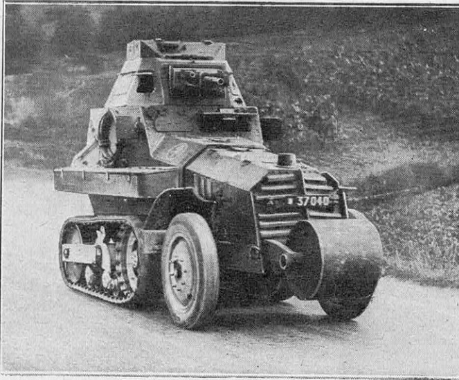
FIG. 5. — AUTOMITRAILLEUSE DE COMBAT, DU POIDS DE 6,2 T, ARMÉE D'UN CANON DE 37 MM ET D'UNE MITRAILLEUSE DE 7,5 MM
