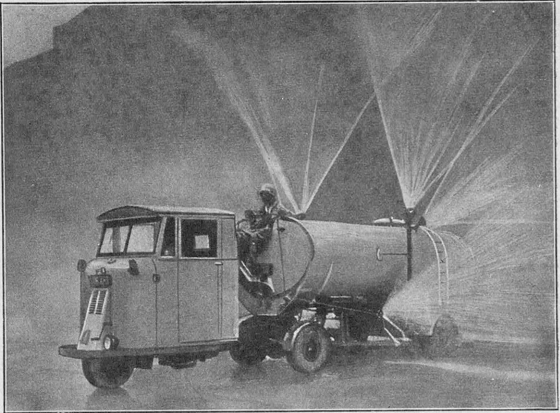
FIG. 7. — VOICI, EN ACTION, LE VÉHICULE QUI A ÉTÉ SPÉCIALEMENT ÉTUDIÉ, EN ANGLETERRE, POUR ASSURER LA DÉSINFECTION DES RUES ET DES FAÇADES DE MAISONS AU MOYEN DE NAPPES D'EAU ET DE JETS PUISSANTS (VOIR PAGE 129 DE CE NUMÉRO.)
