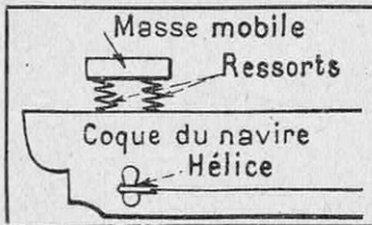
FIG. 8. — SCHEMA DE PRINCIPLE DE L'ABSORBEUR DYNAMIQUE DE VIBRATIONS SUIVANT LE SYSTEME « FRAHM »
