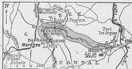
FIG. 7. — CETTE CARTE MONTRE L'IMPORTANCE DU RÉSERVOIR CRÉÉ PAR LE BARRAGE DE MARÈGES (CAPACITÉ, 47 MILLIONS DE M 3 )
