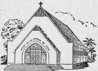
ÉGLISES ET TEMPLES COLONIAUX avec toiture à pente de 80 centim. au mètre. (Notice 214).
