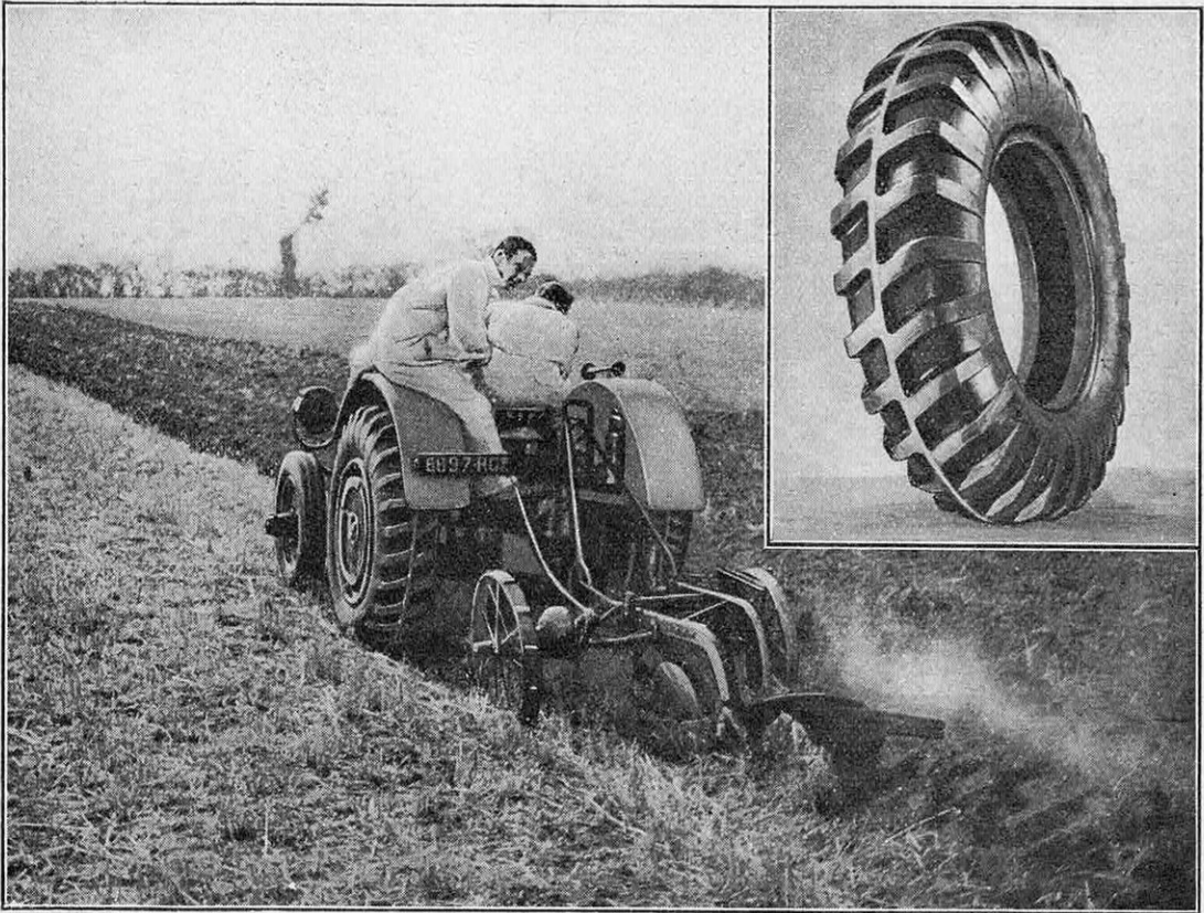
FIG. 5. — TRACTEUR AGRICOLE ÉQUIPÉ DE PNEUMATIQUES SPÉCIAUX A RELIEFS TRÈS ACCUSÉS POUR TERRAINS MEUBLES ET GRANDS EFFORTS DE TRACTION
