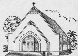
TEMPLE PROTESTANT, à Dabou (Côte-d'Ivoire), en série 39, toiture avec pente de 80 centi- mètres au mètre.
