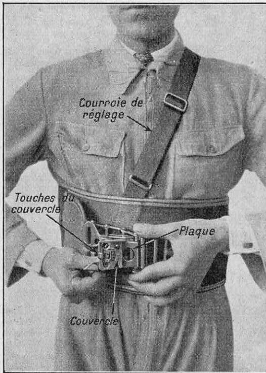
FIG. 1. — HARNACHEMENT ET CEINTURE DU PARACHUTE « SALVATOR »
