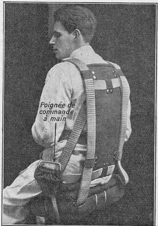
FIG. 2. — TYPE DE PARACHUTE DE SIÈGE « IRVIN » PORTÉ PAR UN PILOTE A gauche, la poignée de commande à main.
