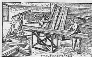
SCIE CIRCULAIRE en acier pour tronçonner les bûches et débitier en long. Un seul modèle : 480 francs. (Notice 36)
