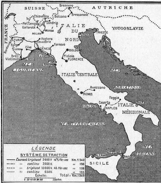
FIG. 1. — ÉTAT ACTUEL DES LIGNES ÉLECTRIFIÉES EN ITALIE, ET DIFFÉRENTS SYSTÈMES DE TRACTION UTILISÉS
