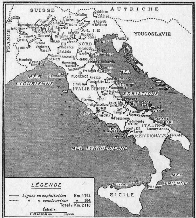
FIG. 8. — CARTE DES LIGNES DE CHEMINS DE FER ITALIENS D'INTÉRÊT LOCAL ÉLECTRIFIÉES ET UTILISANT SURTOUT LE COURANT CONTINU 3.000 VOLTS
