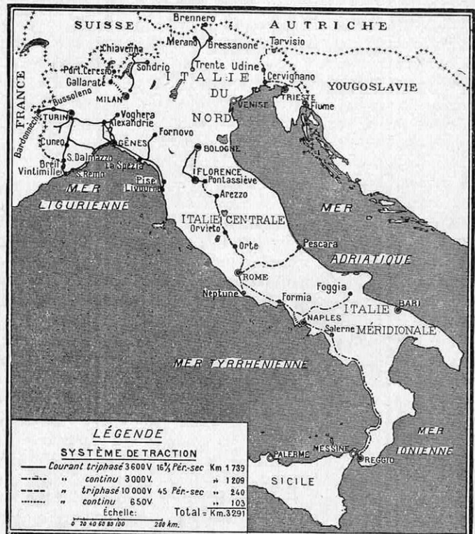
FIG. 2. — CE QUE SERA L'ÉLECTRIFICATION FERROVIAIRE EN 1936. LES MÊMES SYSTÈMES DE TRACTION SONT PRÉVUS (COURANTS ALTERNATIFS JUSQU'À 10.000 VOLTS)
