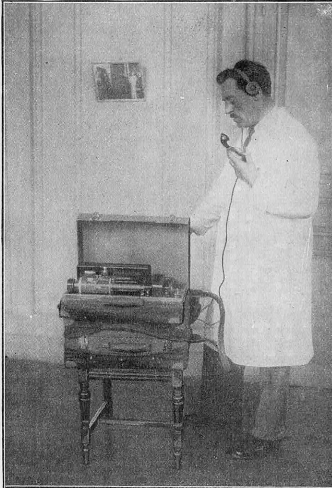
FIG. 5. — UN REPORTER EN VOYAGE EN TRAIN DE TRANSMETTRE UN BÉLINOGRAMME AU MOYEN DES DEUX VALISES DONT LA FONCTION EST DÉCRITE AUX PAGES 304 ET 305
