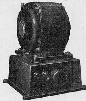
Moteur à trois vitesses Pour commande d'appareil de laboratoire et de démonstration Commande de petites machines-outils
