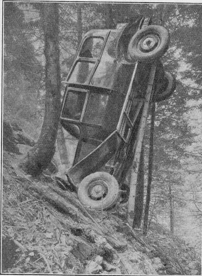
FIG. 10. — CURIEUSE PHOTOGRAPHIE MONTRANT LA SOLIDITÉ D'UNE VOITURE CARROSSERIE TOUT ACIER. La caisse de cette voiture Citroën a résisté et les passagers sont sortis indemnes de cet accident, survenu dans les Vosges.
