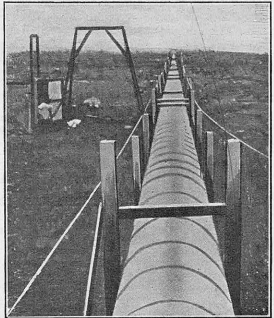
FIG. 6. — VOICI LE TUBE A VIDE DE UN MILLE DE LONG (1.609 METRES), QUI A SERVI AUX DERNIERES EXPERIENCES DE MICHELSON ET DE SES SUCCESEURS
