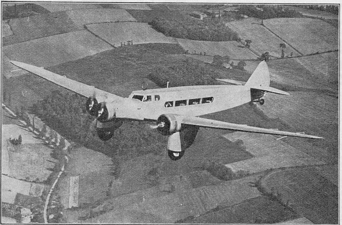
FIG. 4. — LE TRIMOTEUR DE TRANSPORT A GRAND RAYON D'ACTION « DEWOITINE 332 » Cet appareil, entièrement métallique, dont le poids total dépasse 9 tonnes et dont la vitesse est de 265 kilomètres à l'heure, est au nombre de ceux qui pourraient assurer la liaison transatlantique.
