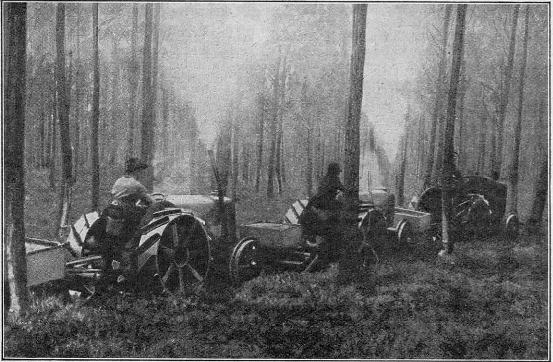
FIG. 2. — L'OPÉRATION MÉCANIQUE DU DÉBROUSSAILLAGE DANS LA FORÊT LANDAISE. Voici les « débroussailleurs » modernes en action pour écraser les sous-bois et les hacher plus ou moins. Cette opération est destinée à dégager les jeunes semis de pins et à favoriser la croissance.
