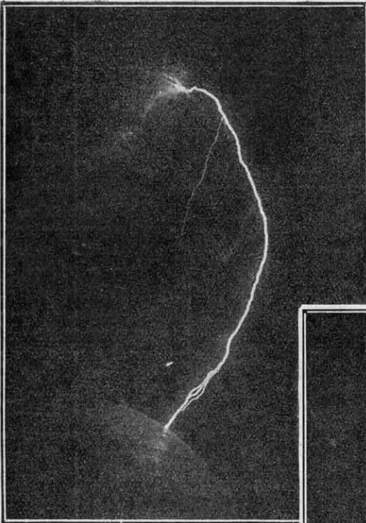
FIG. 2. — UNE « ÉTINCELLE DE CHOC » JAILLISSANT SOUS UNE TENSION DE 3 MILLIONS DE VOLTS ENTRE LES SPHÈRES DE L'ÉCLATEUR DE MESURE
