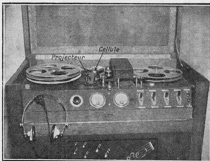
FIG. 3. — ENSEMBLE DE L'APPAREIL ENREGISTREUR ET REPRODUCTEUR COMBINÉS DIT « RUBAN SONORE »
