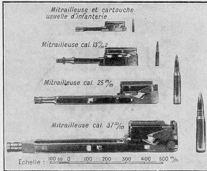
FIG. 13. — TABLEAU MONTRANT LES DIMENSIONS COMPARÉES DES MÉCANISMES ET DES CARTOUCHES DES DIFFÉRENTES ARMES AUTOMATIQUES
