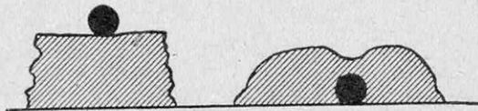
FIG. 1. - UNE BALLE DE PLOMB, POSÉE SUR UN BLOC D'ASPHALTE, FINIT PAR LE TRAVERSER
