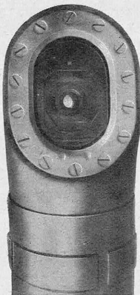
L'« ŒIL » DU PÉRISCOPE Monté à l'extrémité supérieure d'un long tube, cet œil permet d'explorer la surface de la mer.
