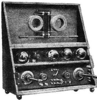
PHOTOGRAPHIE ET MONTAGE DU POSTE DE T. S. F. FONCTIONNANT SUR LE COURANT ALTERNATIF SANS PILES NI ACCUMULATEURS
